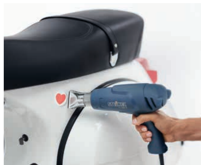
Rimozione. Con l'ausilio dell'aria calda è più facile rimuovere adesivi.
