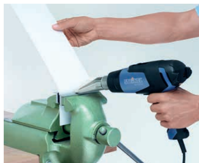
Modellatura. Modellatura mirata della plastica tramite il calore.
